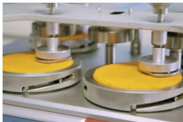
L'appareil d'essai de résistance à l'abrasion Martindale est l'appareil reconnu sur le plan international pour tester la résistance des tissus à l'abrasion et à l'usure. Tilsatec utilise l'appareil M235, qui permet d'obtenir des résultats précis et cohérents. Les matériaux hautes performances peuvent être testés sur plus de 8 000 cycles afin de déterminer le moment où le matériau commence à se dégrader.
