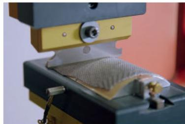
Les essais consistent à tirer une lame droite à la surface d'un échantillon dans un sens, la lame étant remplacée après chaque coupe. Différentes charges sont appliquées tout au long des essais, et la distance de coupe contre la force employée (en newtons) servent à déterminer la force nécessaire pour transpercer le matériau d'un coup de lame de 20 mm.
